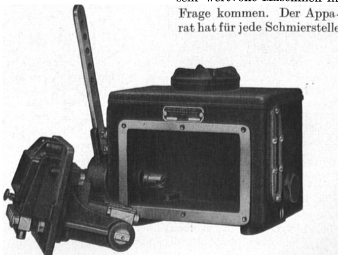
Abb. 44. Grütznert-Zentralöler für höhere Gegendrücke. (Maschinenfabrik Grütznert, Halle a. S.)
