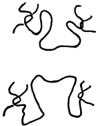
Abb. 5.9. Freiheitsgrade und Deformationsmechanismen im gummi-elastischen Zustand
