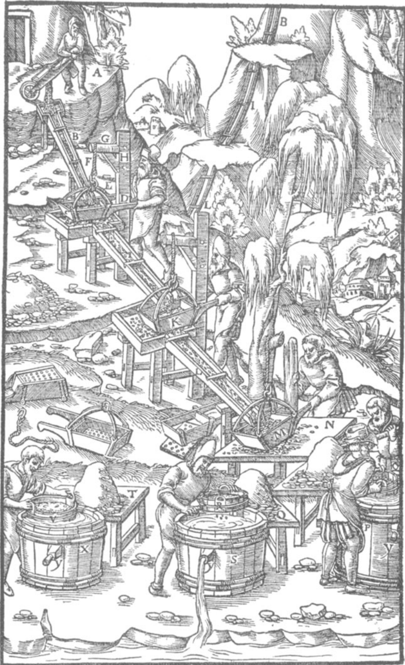
Abb. 1. Aufbereiten von Erzen durch Sieben und Setzen nach einem Holzschnitt aus dem Bergwerksbuch von G. Agricola.
