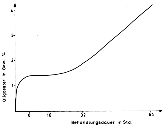
Abb. 8: Oligomerenaustritt bei hydrothermischer Behandlung von Polyesterfasern. Temperatur: 140 °C
