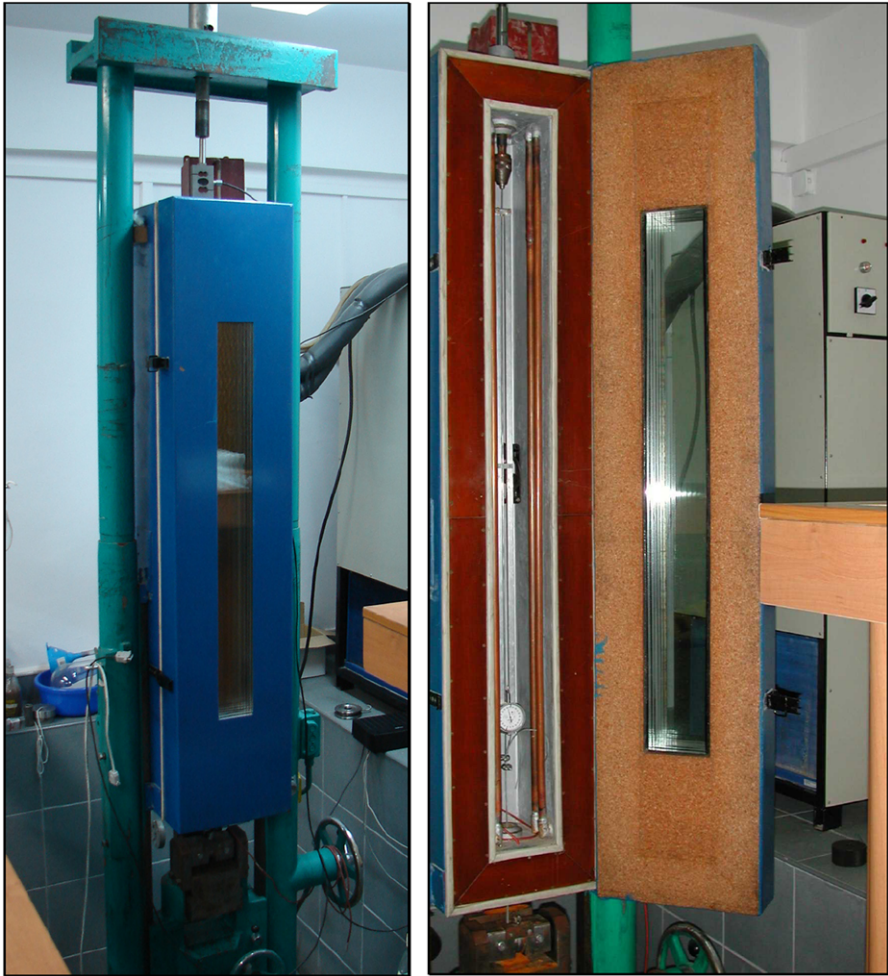
Fig. 2 Wires creep test stand
