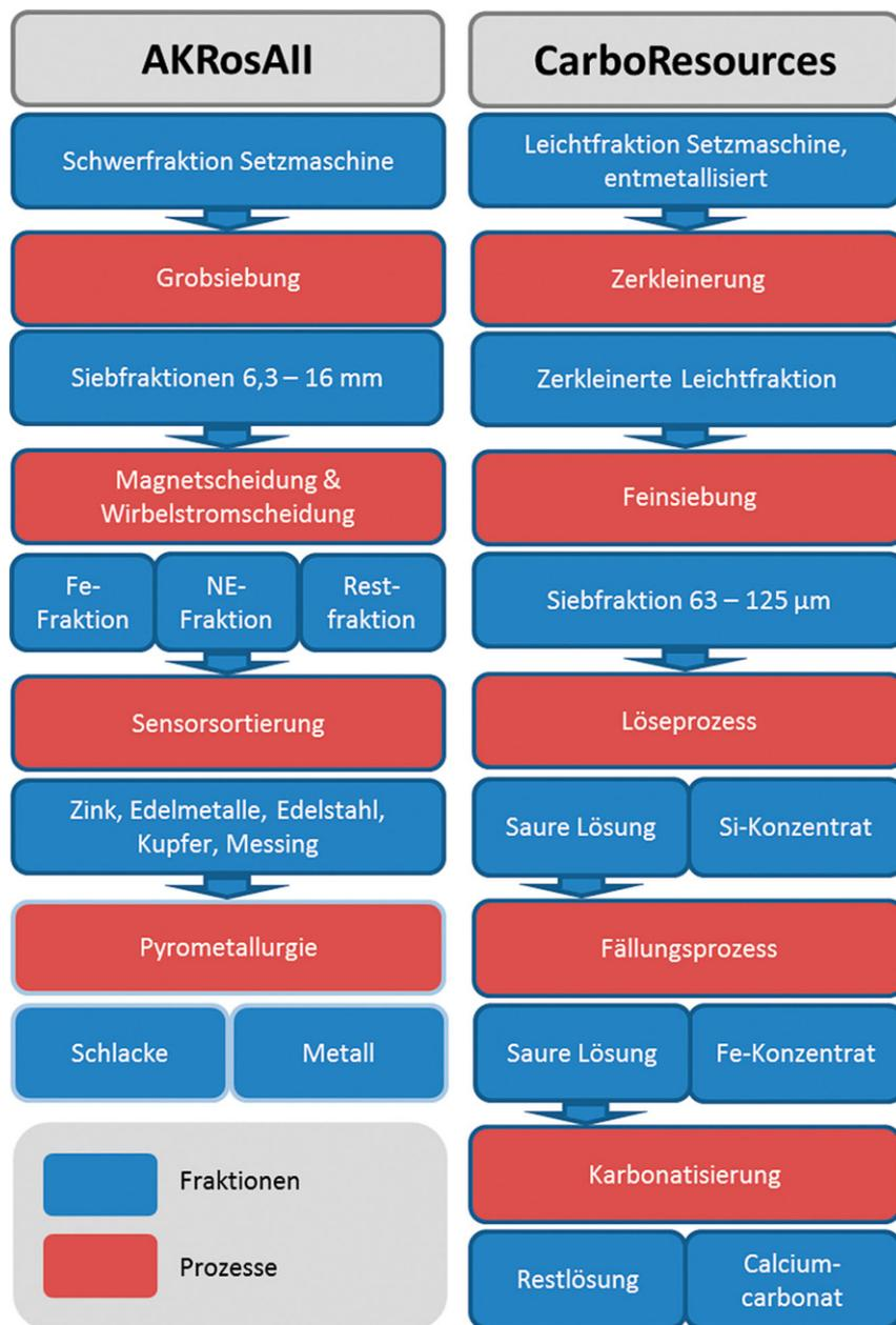
**Abb. 3** Prozessschemata der Projekte AKRosAll und CarboResources
