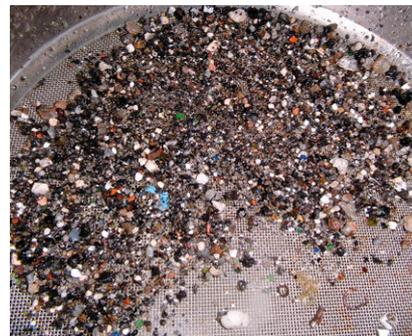
**Abb. 4** MVA-Rostasche nach der elektrodynamischen Fragmentierung
