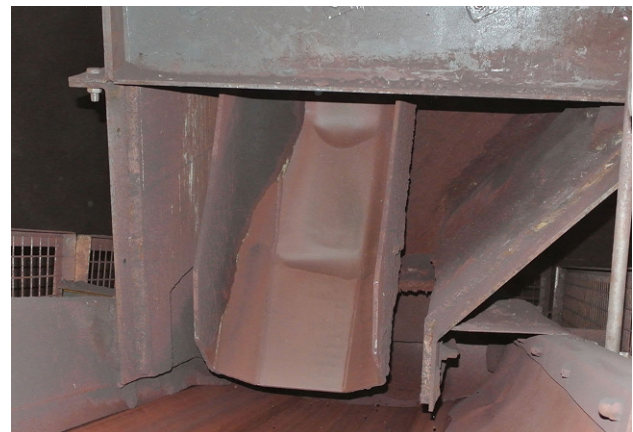
Abb. 2: Standardschurre mit konzentriertem Verschleiß
