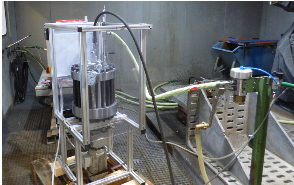
Abb. 1: Versuchsaufbau für die Experimente unter Bohrlochbedingungen
