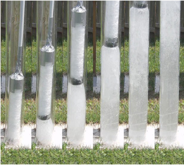
Abb. 1: Versuch eines Befüllvorgangs mit Wasser im transparenten Kunststoffrohr
