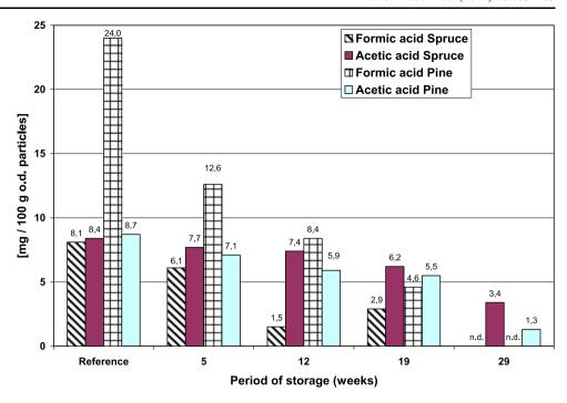
Fig. 2 Release of formic and acetic acid from spruce and pine wood TMP-fibres obtained from unstored wood and after storage for 5, 12, 19 and 29 weeks, measured by the flask method (24 h-value) (according to the principles of EN 717-3) Abb. 2 Abgabe von Ameisenund Essigsäure aus TMP. hergestellt aus ungelagertem und für 5, 12, 19 und 29 Wochen gelagertem Fichtenund Kiefernholz, ermittelt mit Hilfe der Flaschenmethode (24 h-Wert) nach dem Prinzip der EN 717-3
