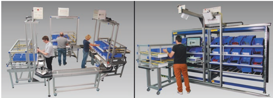
Abb. 3.2 Assistenzsysteme in einer Montagezelle (links), Assistenzsystem für Kommissionierprozesse (rechts)
