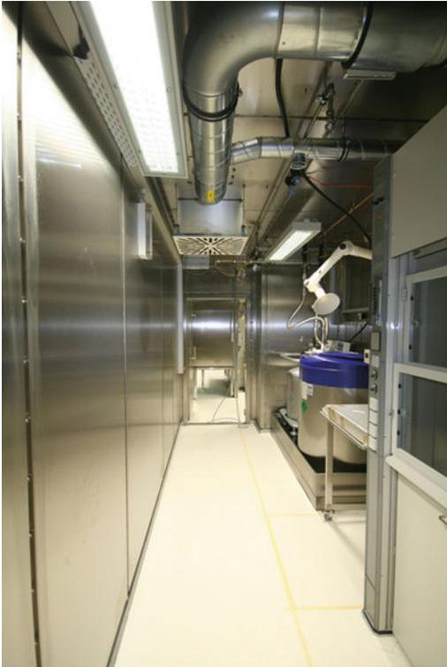
**Abb. 3** Großgeräteraum im BSL-4-Labor mit Flüssigstickstofflagerbehälter (Fa. Cryotherm)
