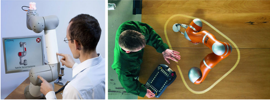
Abb. 6 Neue Schnittstellen, wie eine resistive Sensorhaut ( links ), erlauben eine einfache Programmierung am Roboter selbst und moderne Projektionstechniken ( rechts ) ermöglichen sowohl eine intuitive Antizipation der Aktionen des Roboters als auch das ortsnahe Einblenden von relevanten Informationen für den Benutzer, Quelle : Fraunhofer IFF
