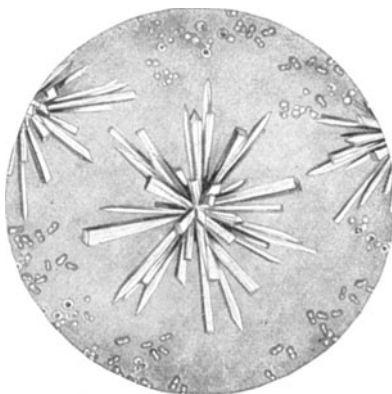
Abb. 64. Krystalle von einfach saurem phosphorsaurem Kalk, daneben die Kugel- und Biskuitformen des kohlensauren Kalks.
