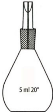
Pyknometer · Abb. 1 Pyknometer mit Kapillarstopfen
