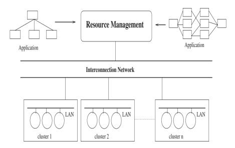
Fig. 1. Multicluster Computing System
