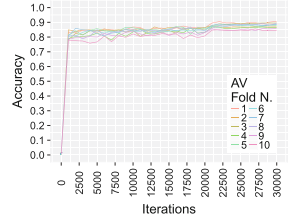
Fig. 10. AV net ten cross-fold validation fine-tuning test accuracy for Yahoo data set.
