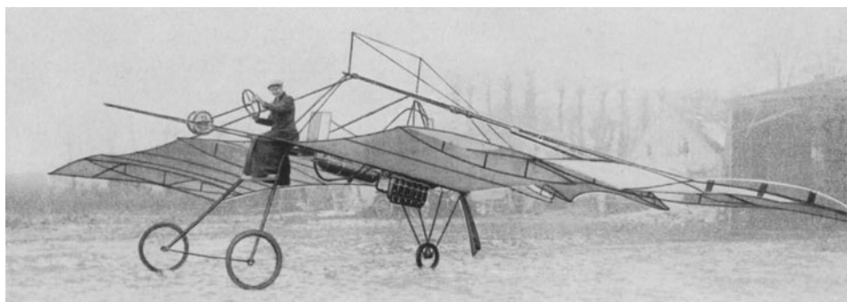
Bild 365. Flugzeug mit eingebautem Jastram-Motor (1912) Das Flugzeug konnte nur Sprünge machen; zu fliegen ist ihm nicht gelungen
