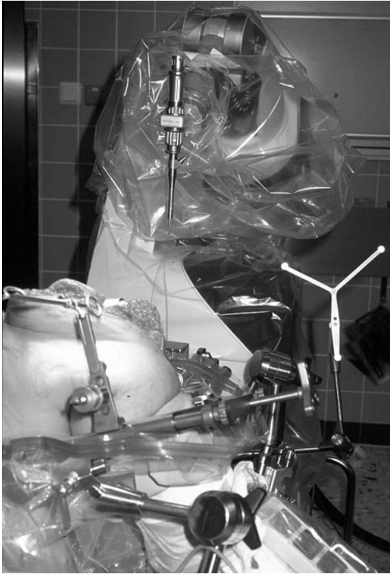
Abb. 2. Operationsroboter CASPAR, Op-Aufbau mit passiven Navigationsmarkern
