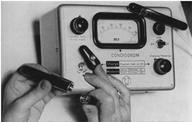
Abb. 12. Auflade- und Ablesegerät „Condiognom“ mit Füllhalterdosimetern der Physikalisch-Technischen Werkstätten, Freiburg i. Br.
